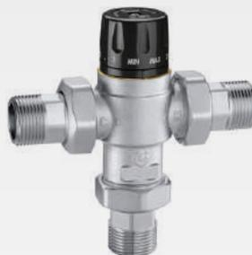
Instale a VÁLVULA MISTURADORA TERMOSTÁTICA ao longo da linha de entrada de água ligada ao coletor solar, a jusante do bloqueador de refluxo. Conecte um ramo da linha de água "fria" para a parte inferior. A temperatura da água doméstica deve ser ajustada conforme necessário dentro do intervalo de 35-55 ° C. Use o botão de ajuste para fazer isso.
